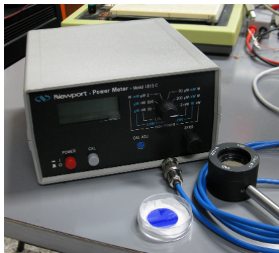
Figura 4.7: da sinistra in senso orario: Power Meter Newport 1815-C, fotorivelatore Newport 818-UV, filtro interferenziale
